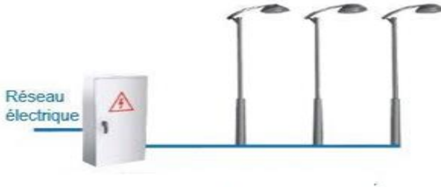
Figure (I.3) : l'éclairage conventionnel (connecté au réseau électrique)
