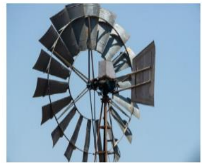
Eolienne à pompage d'eau d'axe horizontal
