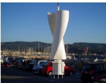
Eolienne hélicoïdale "Windside" d'axe vertical
