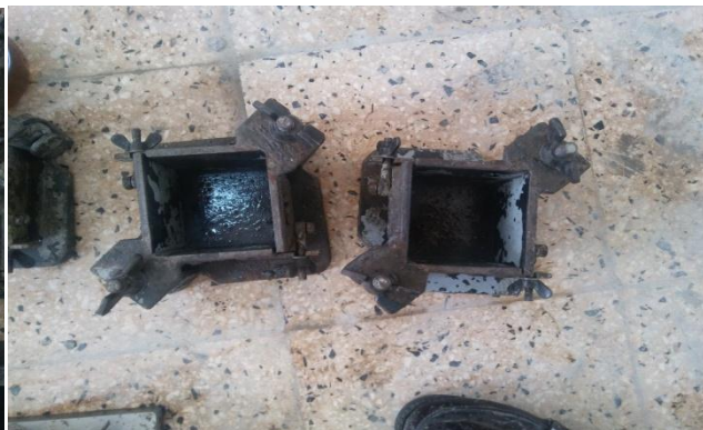
Figure II. 29 : Moule prismatique ( 4 \times 4 \times 16 \text{ cm}^3 ). Figure II. 30 : Moule cubique ( 10 \times 10 \times 10 \text{ cm}^3 ).
