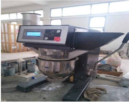
Figure II. 25 : Malaxeur du mortier.
