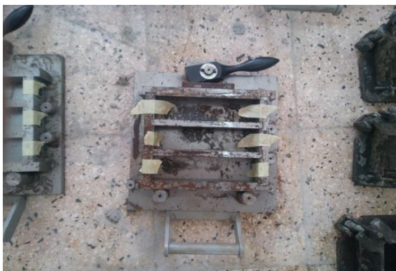
Figure II. 29 : Moule prismatique ( 4 \times 4 \times 16 \text{ cm}^3 ). Figure II. 30 : Moule cubique ( 10 \times 10 \times 10 \text{ cm}^3 ).
