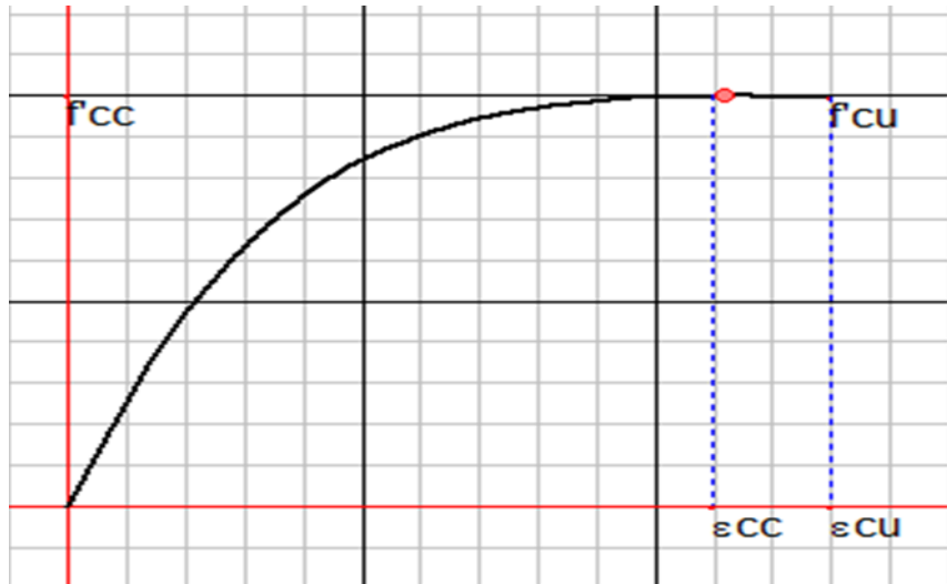
Figure IV.2 : Diagramme parabolé-rectangle des Contraintes-Déformations du béton
