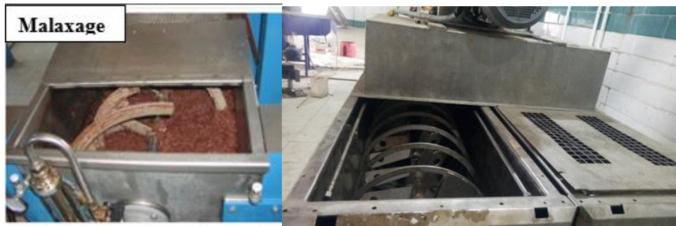
Photos I.4 : Le malaxage (bassin de malaxage)
