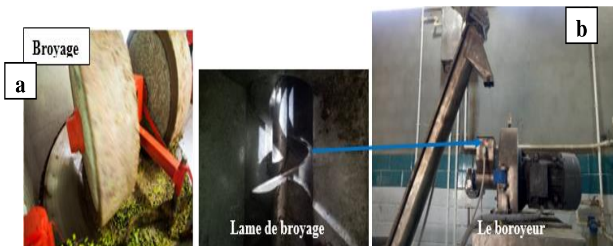
Photos I.3 Le broyage : a) A gauche broyage traditionnelle b) A droite gauche broyage moderne
