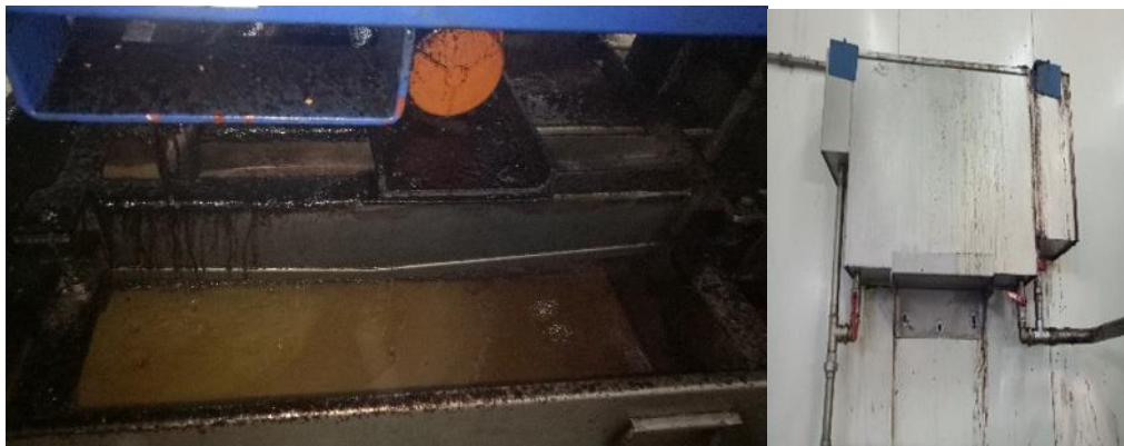
Photos I.8: Séparation des phases liquides (Huile)-liquides (margine)
