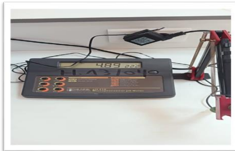
Photo I.14 : Microprocesseur pH Mètre "Hanna pH 210"
