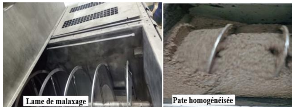
Photos I.5 : L'homogénéisation de la pâte après le malaxage
