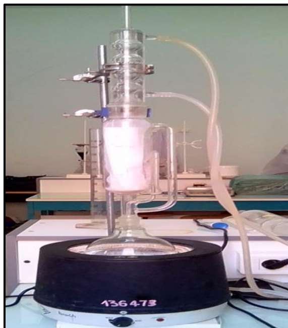
Figure 06 : L'appareil d'extraction (soxhlet).
