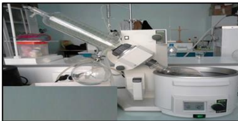
Figure 07 : L'appareil rotavapeur type BUCHRI.
