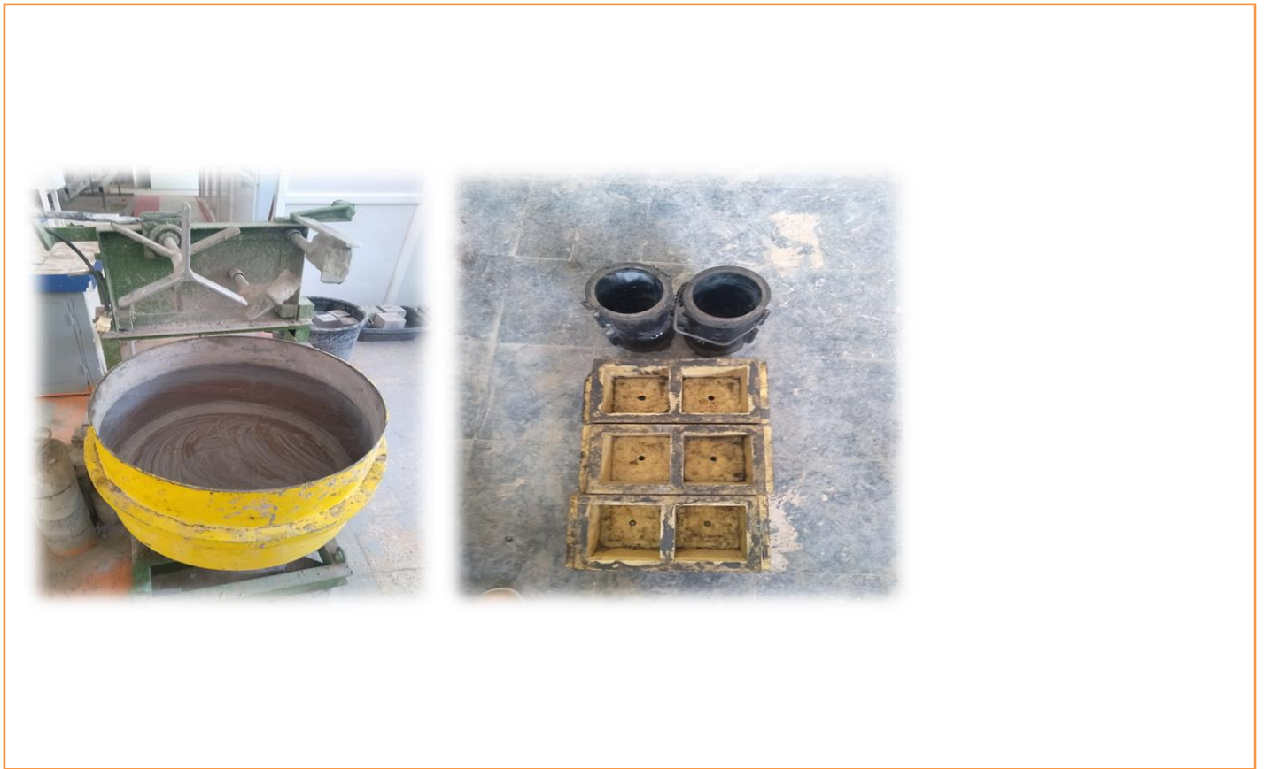
Figure III.16 le malaxeur utilisé et Eprouvettes cubique et cylindrique
