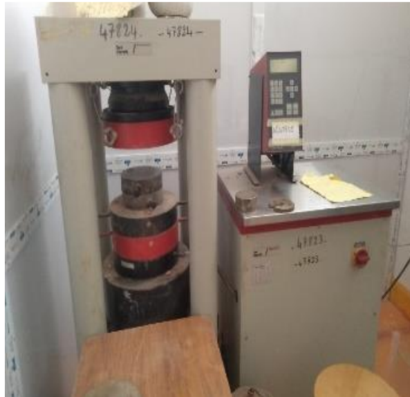
Figure III. 21: Presse hydraulique pour l'essai de compression (avec une pression de 300KN).
