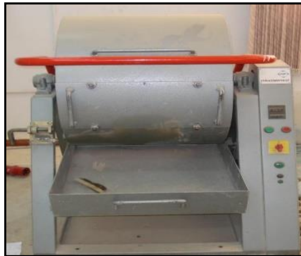
Figure III.4 : Appareil de l'essai Los Angeles.
