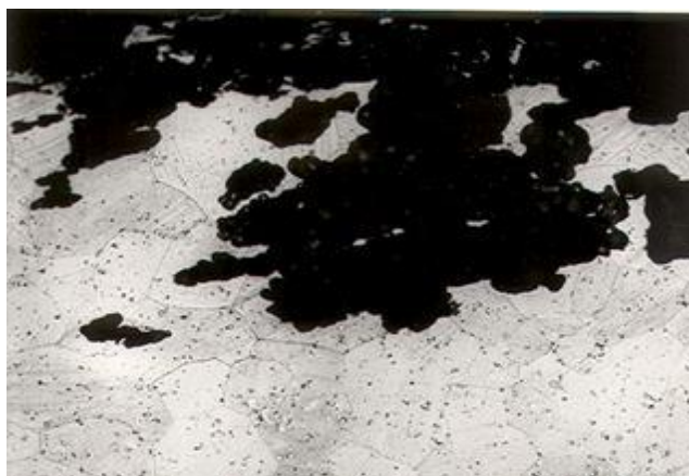
Figure III.3: Coupe d'une piqure sur un alliage d'aluminium type 2000, microscope optique, grossissement \times 200 ) [8]
