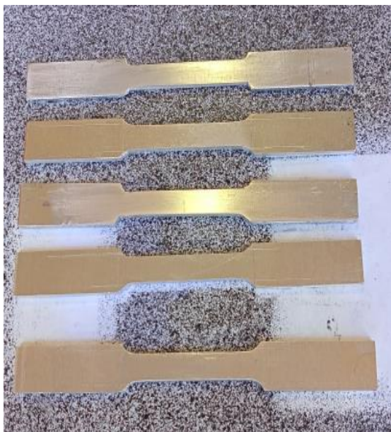
Figure II.6: Eprouvette de fatigue usinées et polies.
