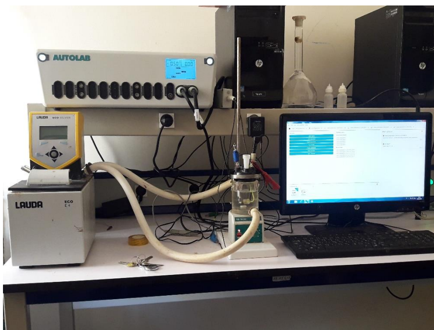
Figure III.8 : Dispositif expérimental des tests de polarisation
