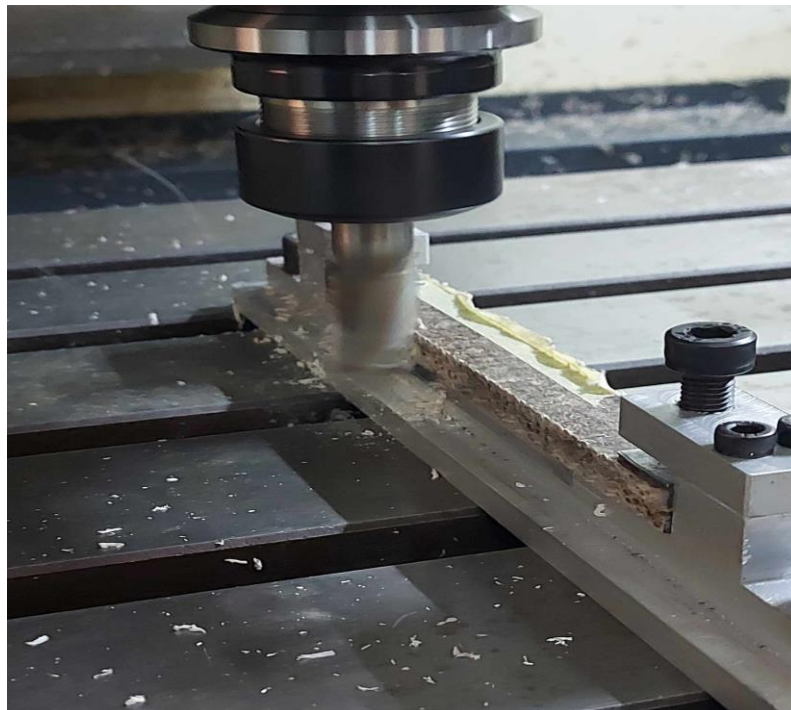
Figure 18 : Exécution du programme d'usinage éprouvette.
