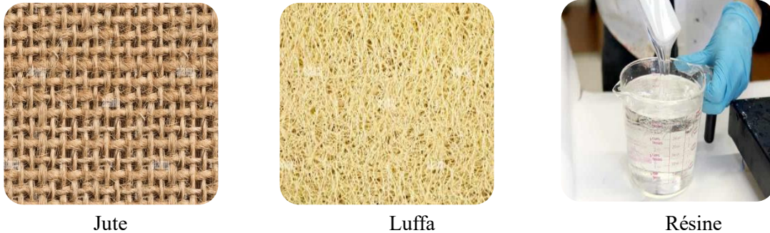
Figure 06 : les différents matériaux du composite hybride
