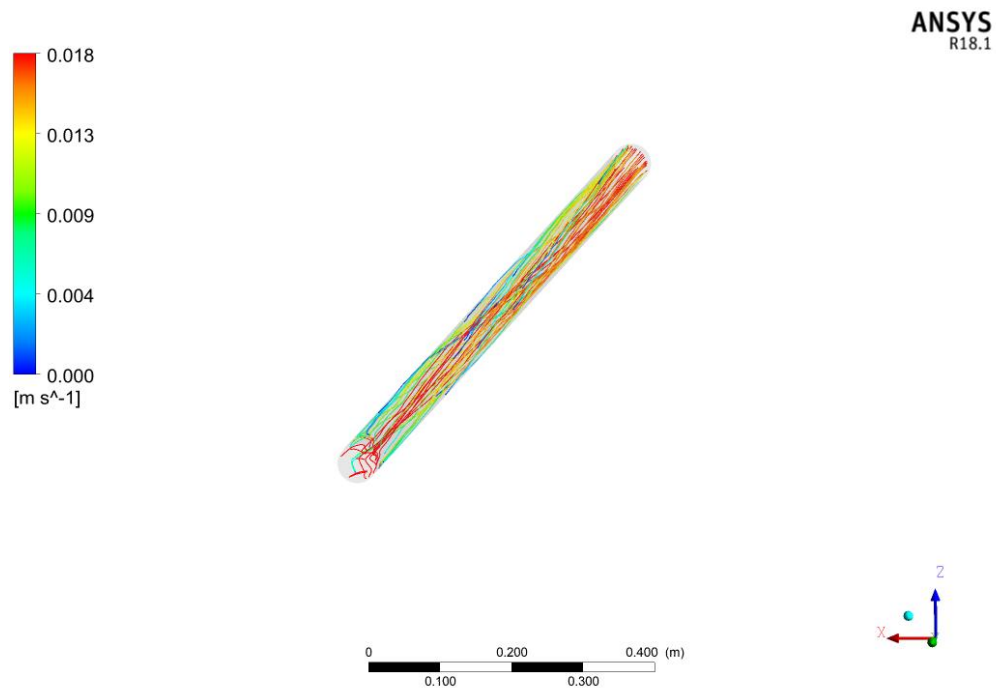
Fig IV.17 Lignes de courant pour une concentration \phi=1\% ( Re=1000 )
