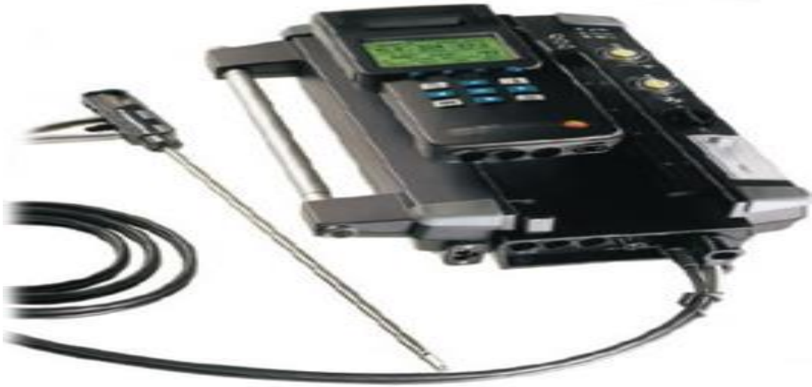
الصورة رقم (21): جهاز قياس الغازات و الإنبعاثات وتحليلها
