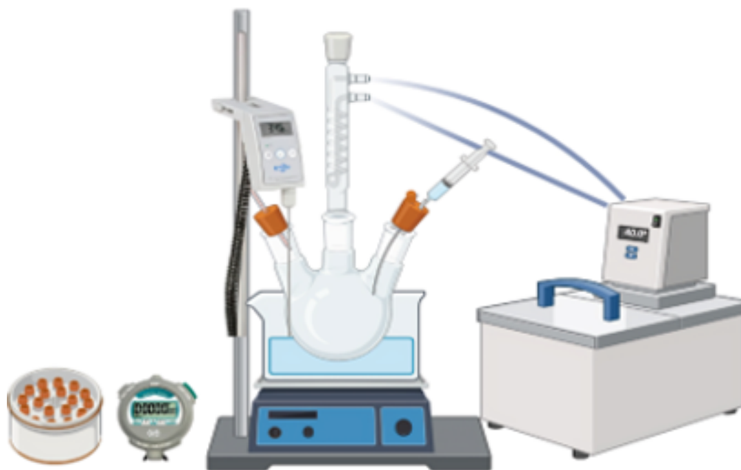
FIGURE III.1 – Appareillage expérimental destiné à l'étude de la dégradation des colorants
