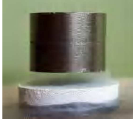
Fig.I.3 : Aimant en lévitation au dessus d'une pastille supraconductrice.
