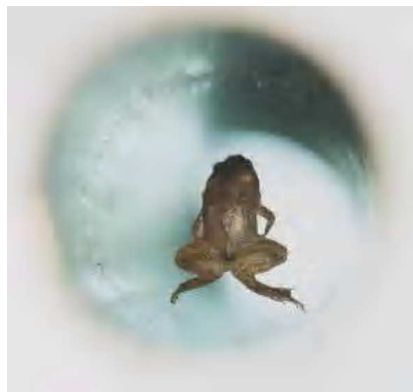
Fig.I.4 : Exemple de lévitation d'un corps diamagnétique.
