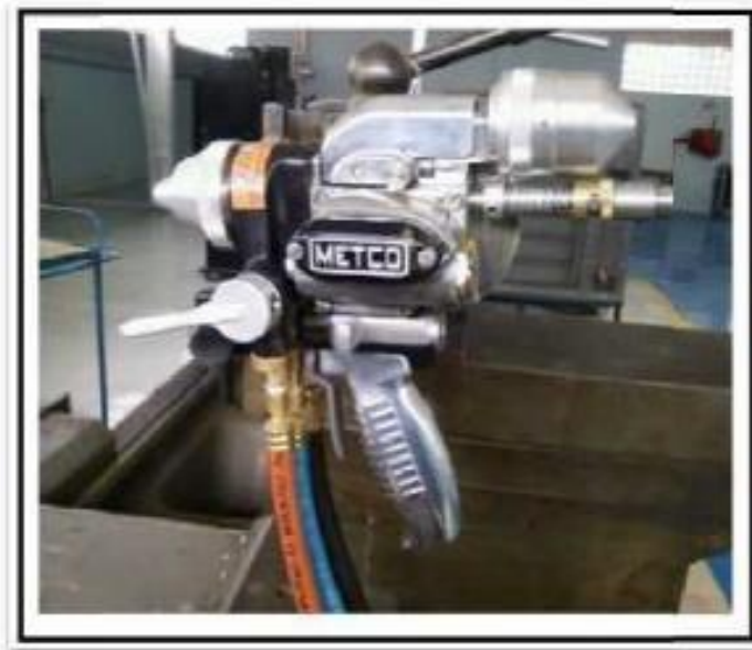
Figure-II.1 : pistolet de projection flamme-fil.
