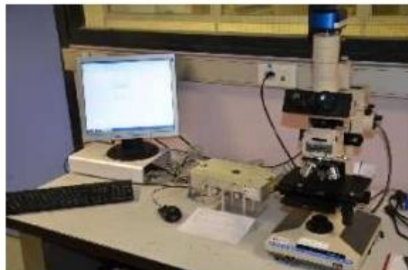
Figure-II.9 Microscope optique en transmission et réflexion OLYMPUS BH2
