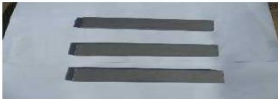
Figure-II.4: les substrats après le sablage
