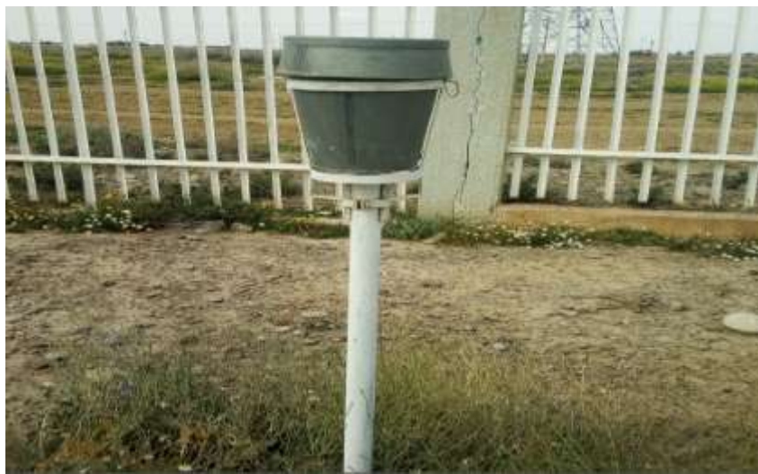
Figure(III.11) pluviomètre de la station météorologique de Msila.
