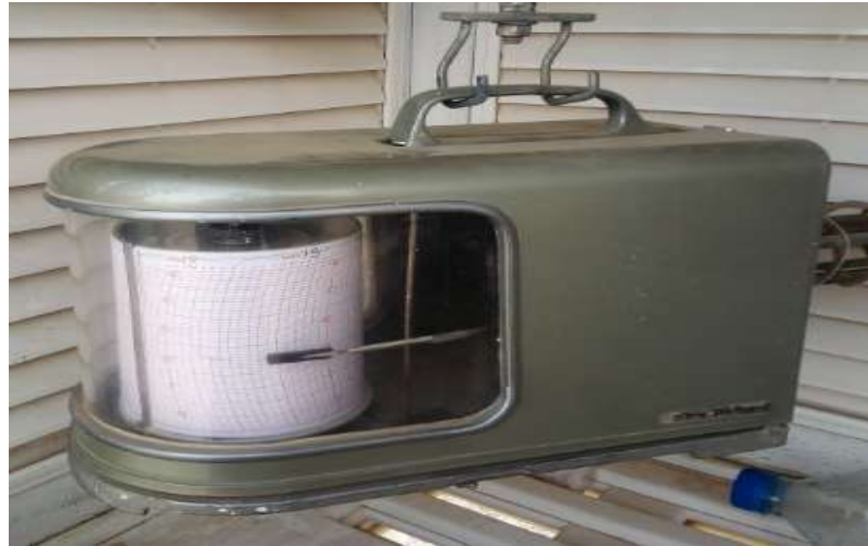
Figure(III.5) thermographe de l'abri météorologique de Msila.
