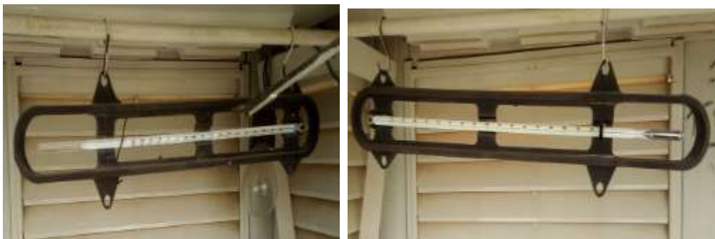
Figure(III.6) thermomètre à maxima-minima sous -abri de la station de Msila.
