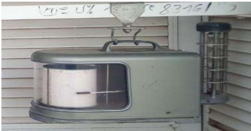
Figure(III.8) hygro-graphe de labri météorologique de Msila.
