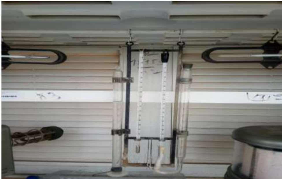
Figure(III.4) Thermomètre à mercure de l'abri météorologique de Msila.
