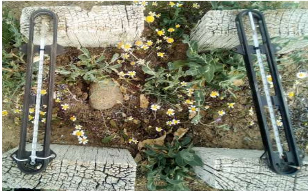
Figure(III.7) Thermomètre à maxima-minima au dessus de sol à la station de Msila.
