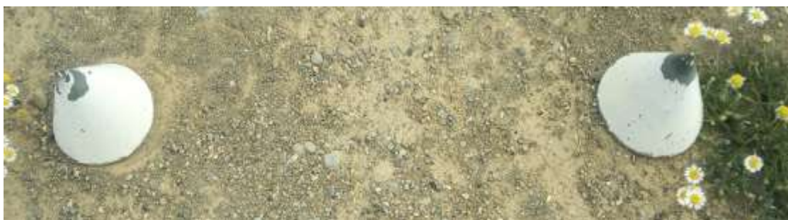
Figure (A) (III.12) Mesure de la température du sol à la station de Msila.
