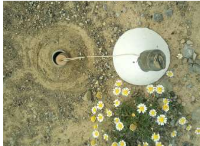
Figure (B) (III.12) Mesure de la température du sol à la station de Msila.
