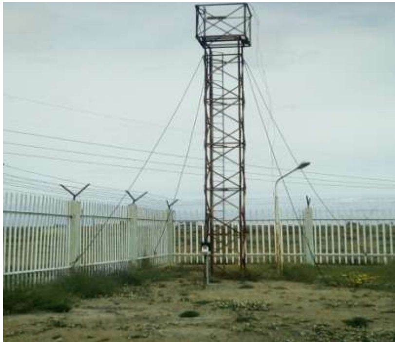
Figure(III.10) Anémomètre de la station météorologique de Msila.
