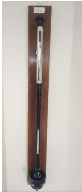
Figure(III.9) baromètre à mercure de la station météorologique de Msila.
