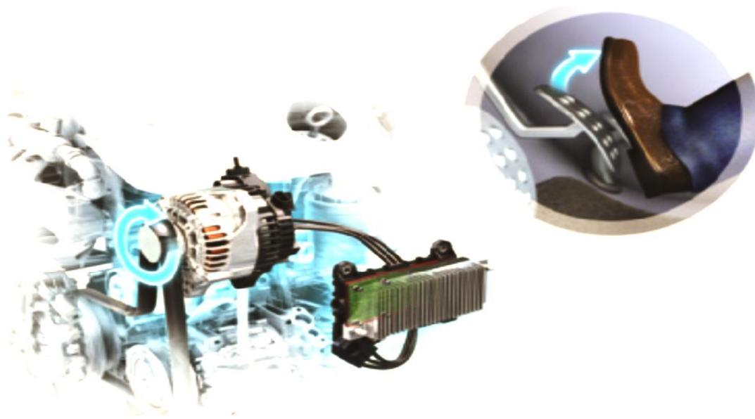
Figure I.2 : Principe de la Fonction (Stop-Start), [4].
