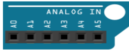
Figure 3.3 : Les Entrées Analogiques
