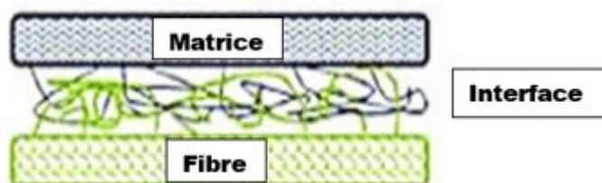
Figure 2.22 : Mécanisme d'adhérence entre fibre et matrice à l'interface : par enchevêtrement moléculaire [126]
