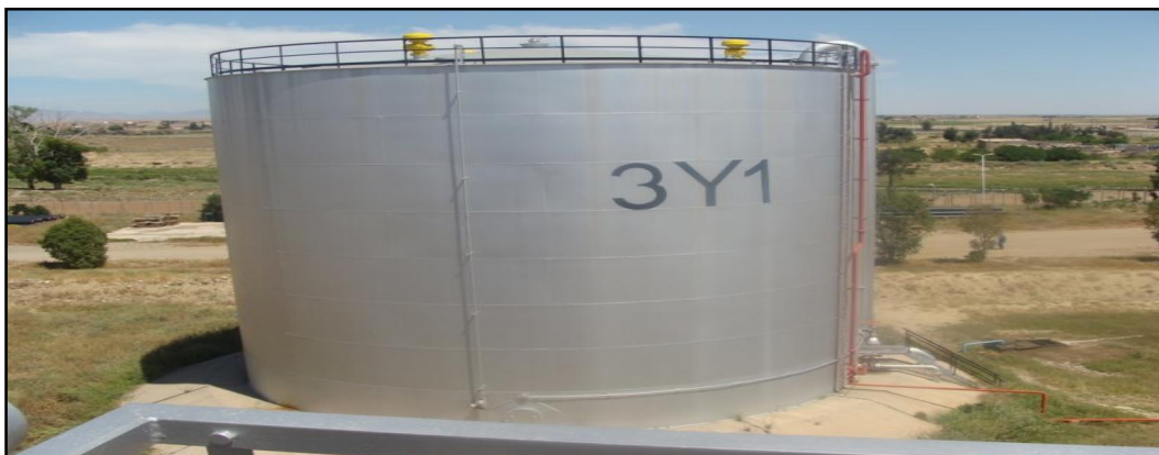
Figure III-6 : Bac de détente 3Y1.
