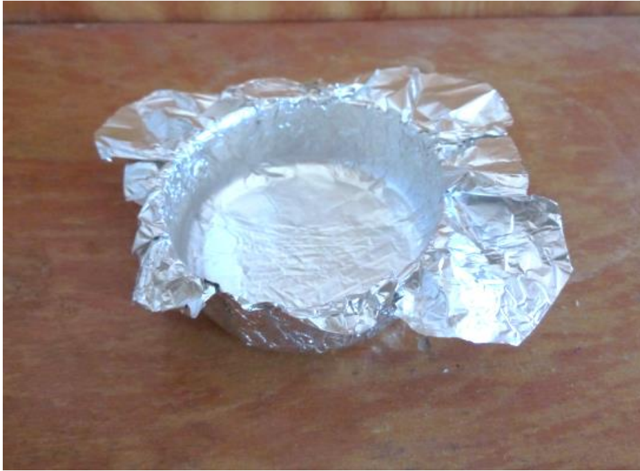
Figure 17. D' défaut d'emboutissage : Formation des plis
