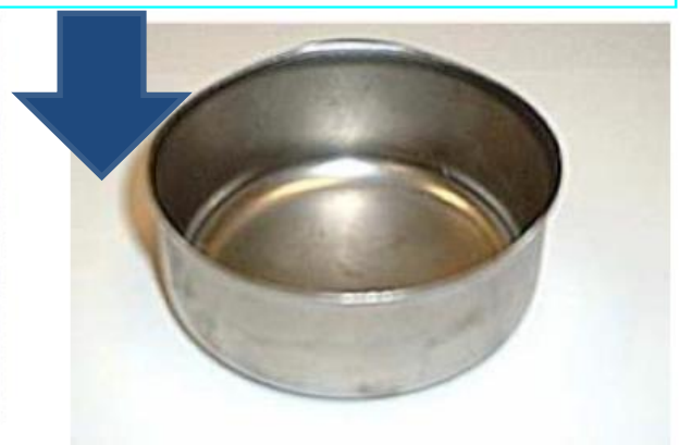
Figure 8. a) Emboutissage par expansion, b) Emboutissage profond avec rétreint. et Exemples des pièces
