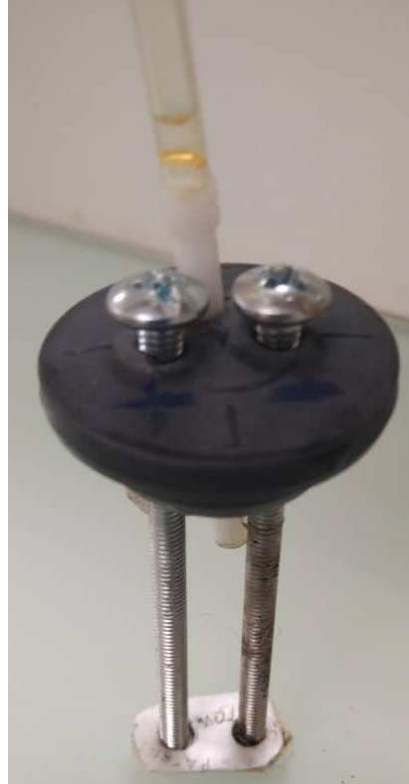
Figure II.2 : Montage des électrodes et de la tige de guidage dans le bouchon.
