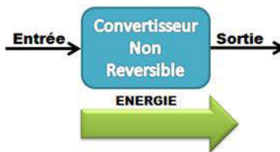
Figure III.4 Synoptique d'un convertisseur DC-DC non réversible.
