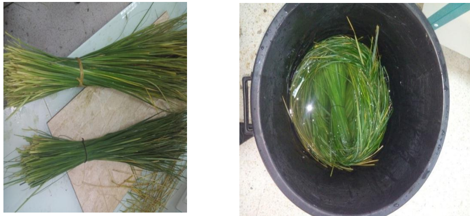
Figure. IV.4 Fibre de DISS : a) avant et b) après immersion dans la solution NaOH.
