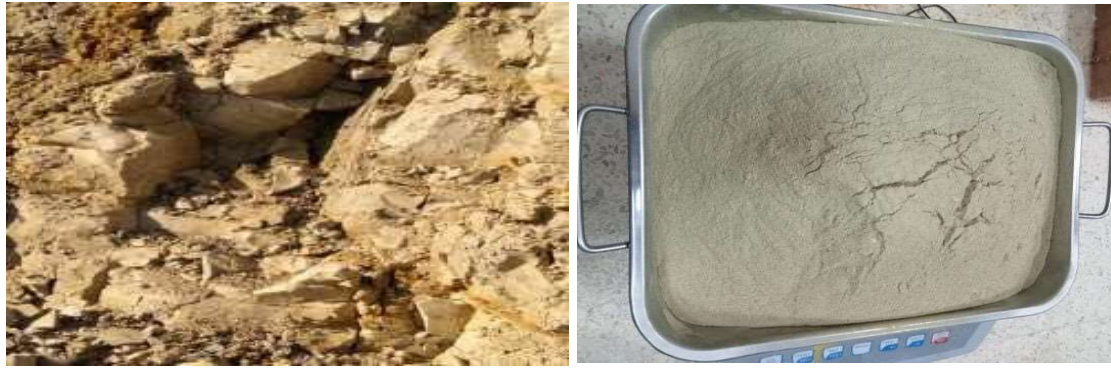
Fig. 1.2 : Aspect du sol de Sidi Hadjres a) intact, b) broyé
