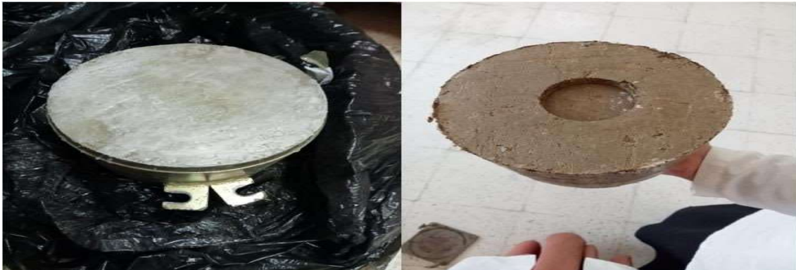
Fig. 2.3 : Les éprouvettes de CBR avant et après l'exécution de l'essai.
