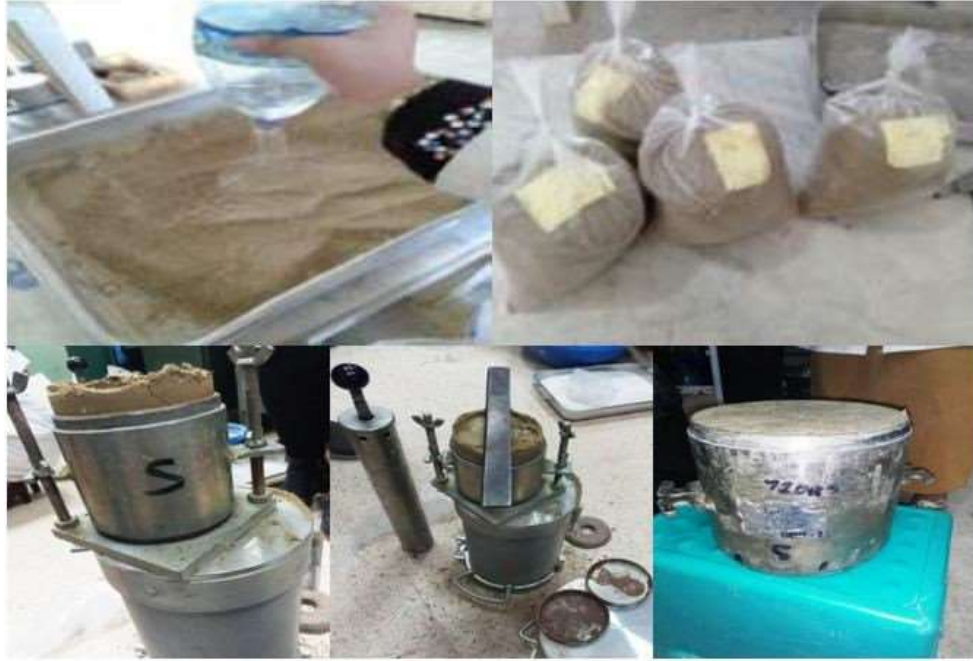
Fig. 2.1 : Préparation des essais de compactage
