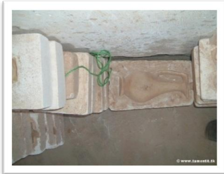
الصورة 21: توضح قالب صنع الفخار المصدر: www.tamentit.tk
