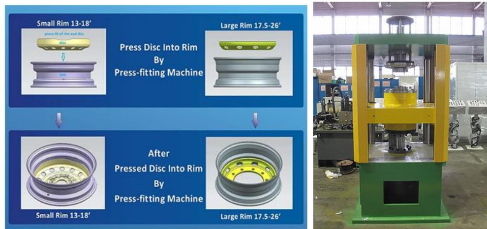
Figure III.12. Pressage du disque sur la jante [54].
