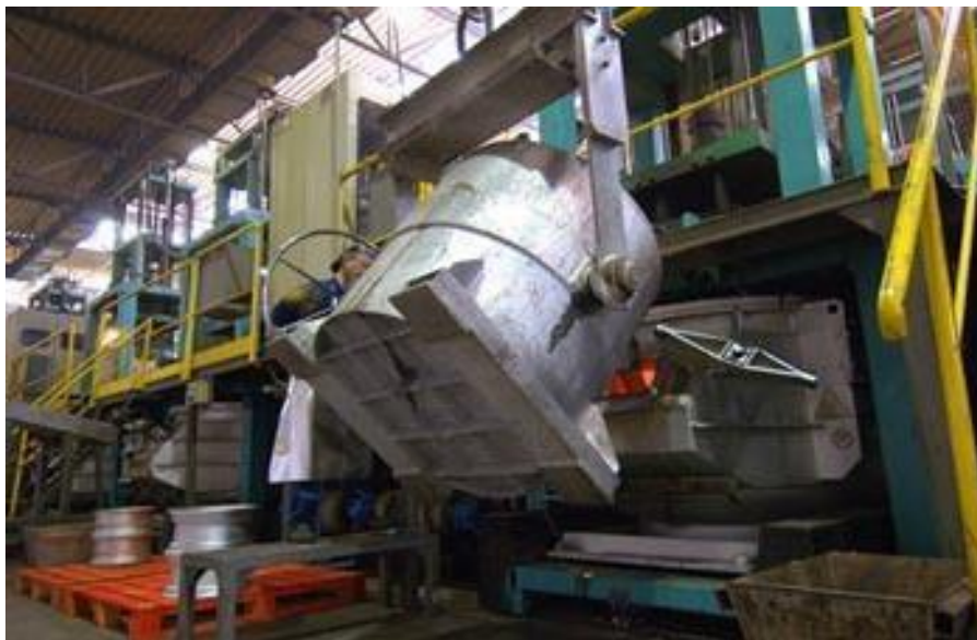
Figure III.18. Opération de coulée d'alliages de jantes [4].
