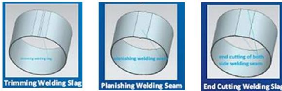
Figure II 6. Tronçonnage et ébarbage de la tôle [54].
