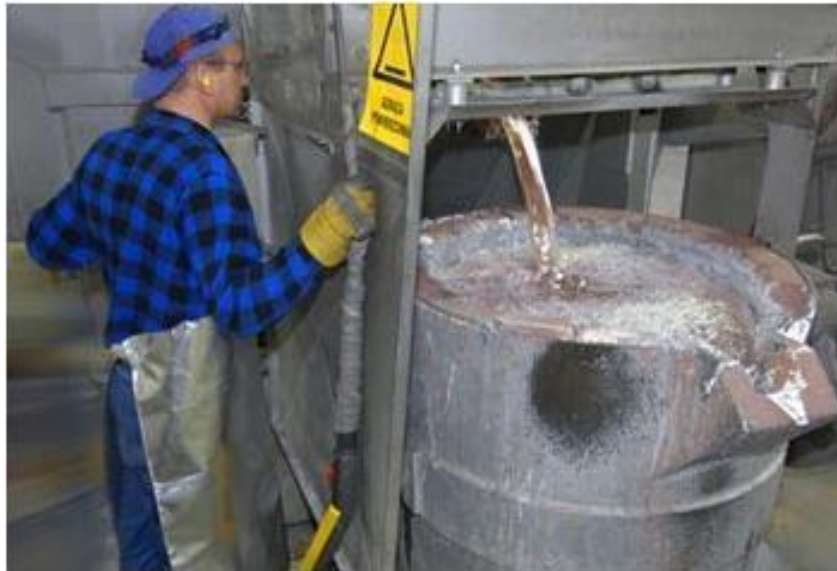
Figure III. 19. Remplissage du creuset par le laitier de coulée [56].
