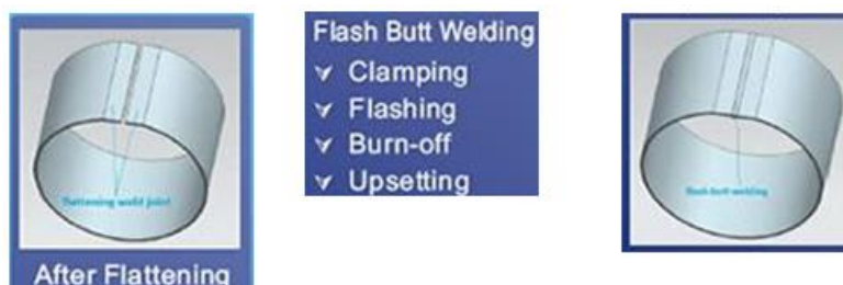
Figure II 5. Confection de tôles en tambours par soudage en bout [54].
