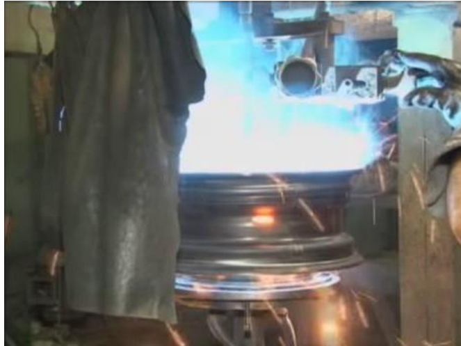
Figure III.13. Soudage Mig-Mag du disque à la jante [53].
