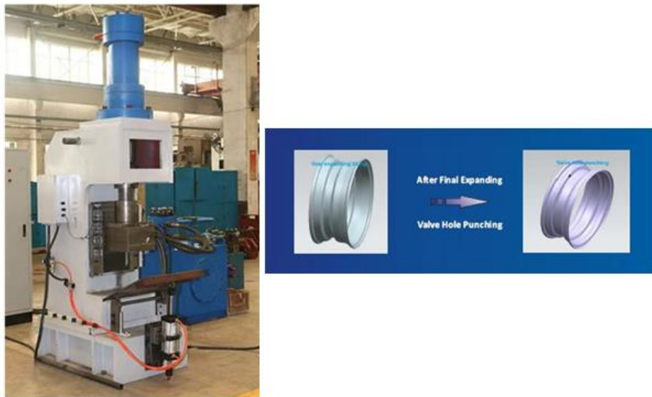
Figure II.10. Poinçonnage du trou de la valve [54].
