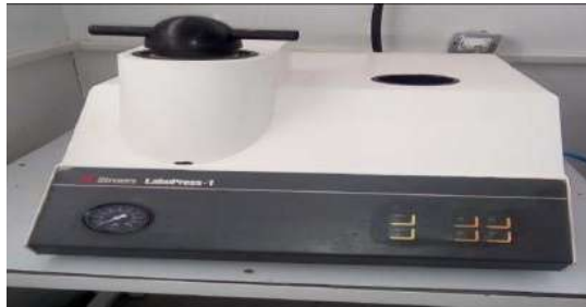
Figure IV.09 : Enrobeuse au niveau de CRTI.
