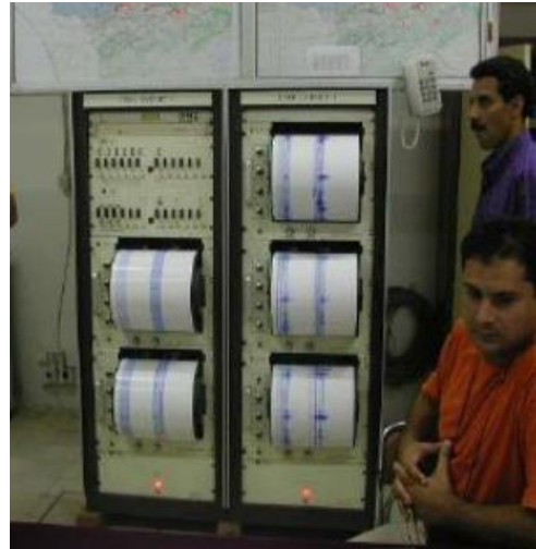
Figure I.10: Fonctionnement d'un sismographe.
