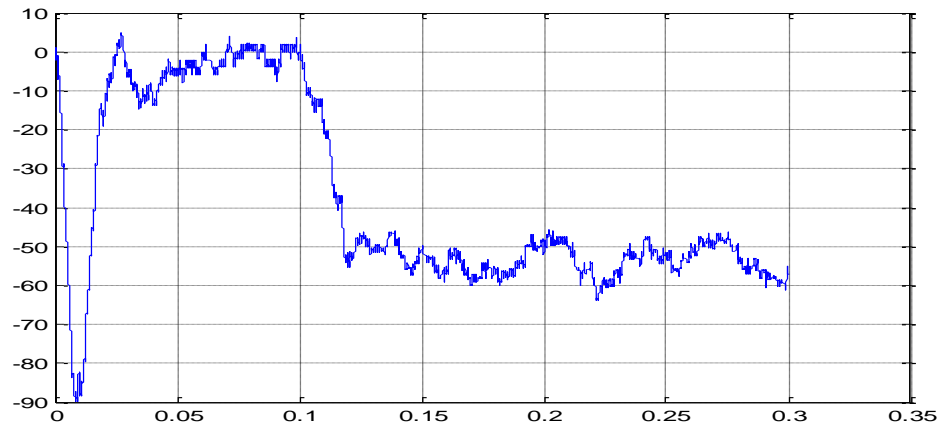
Figure (III.22): Valeur moyenne au point milieu défaillant T4
