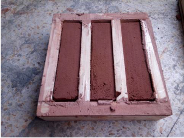
Fig. 1. Eprouvettes des échantillons étudiés (fibre de palmier / argile rouge).
