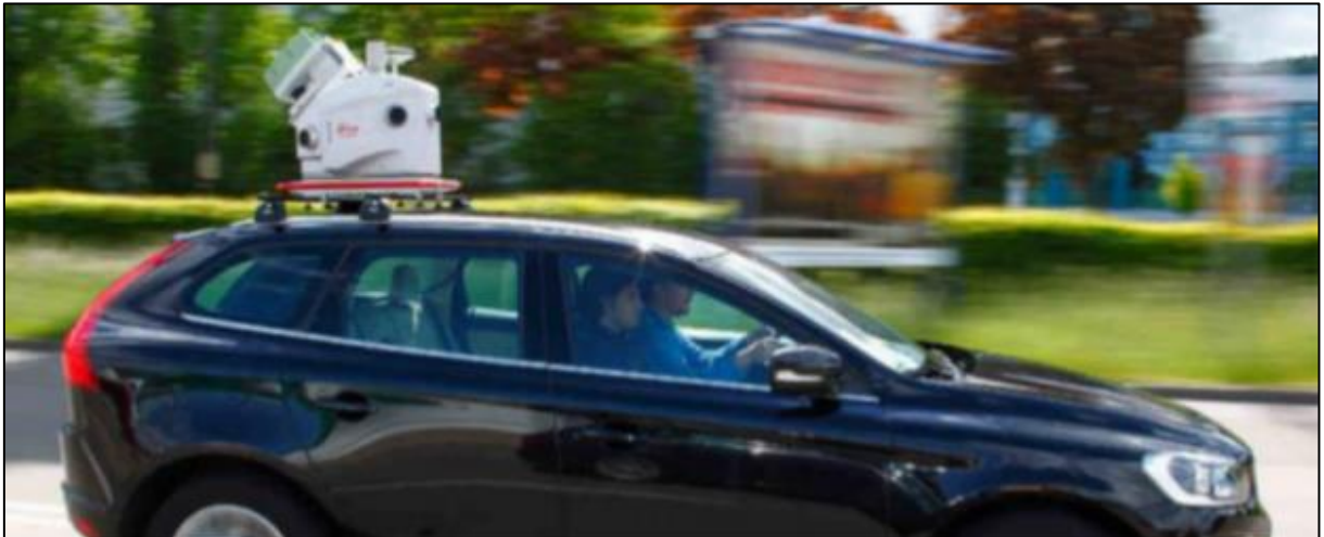
Figure I.10 : Un appareil Leica Pegasus Two installé sur une voiture [13]
