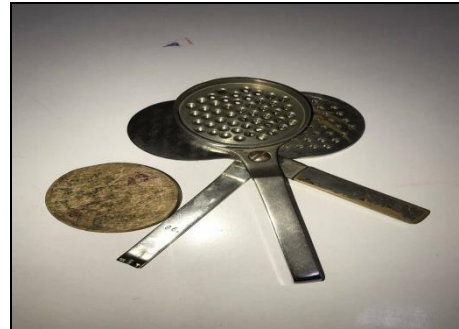
Détermination de mitadinage par Farinotome de Pohl.
