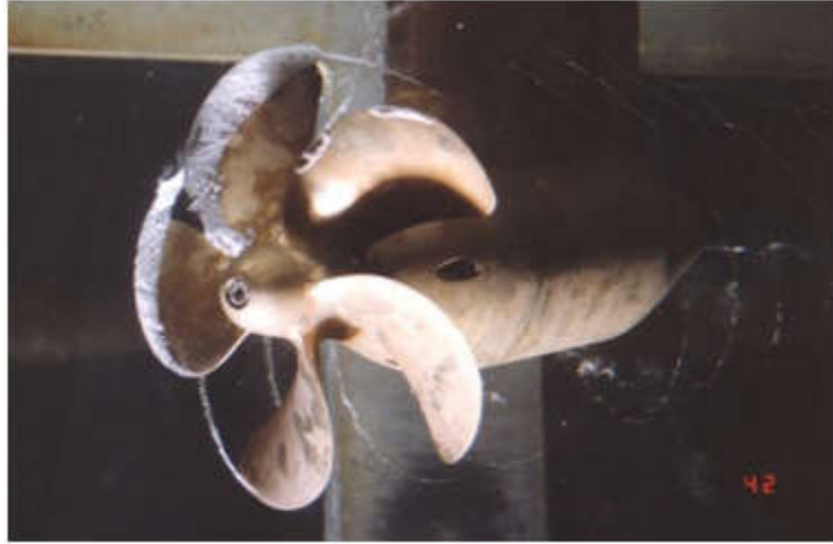
Fig. II.5 Cavitation à lames sur une pale d'hélice
