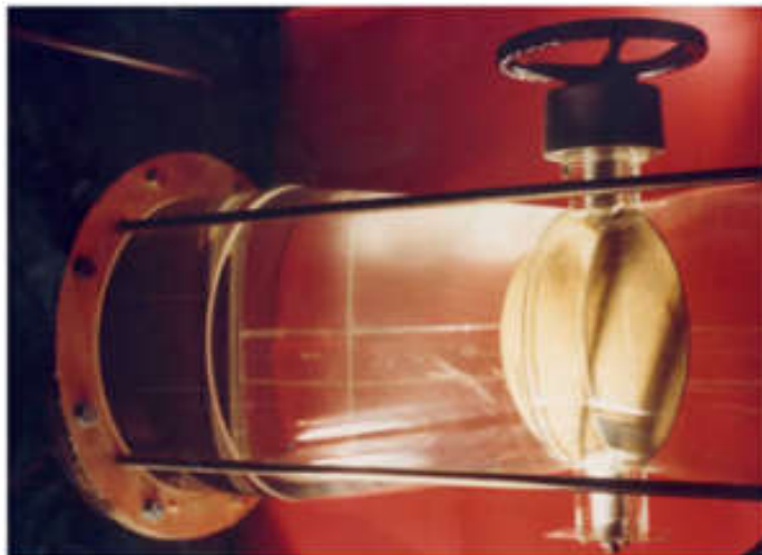
Fig. II.8 Cavitation de mélange en aval d'une vanne papillon
