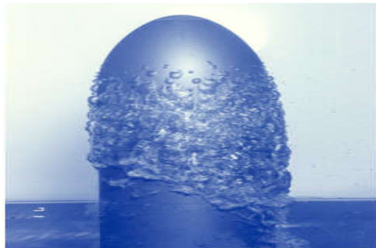
Fig. II.4 Cavitation à poches sur un engin sous-marin
