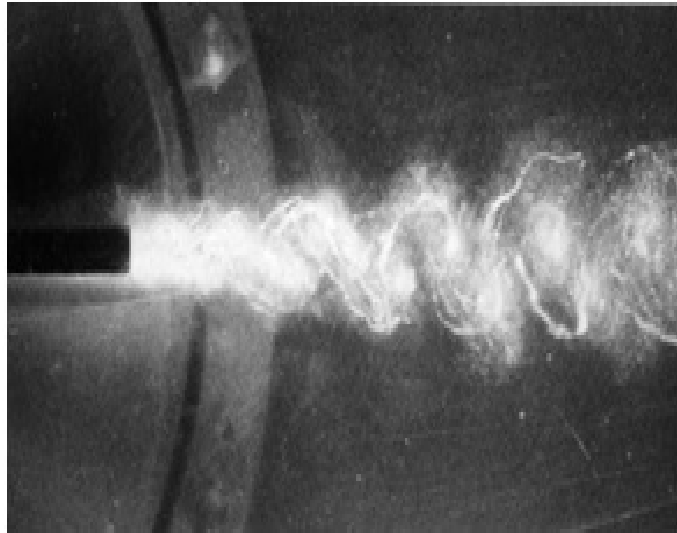
Fig. II.7 Tourbillons cavitants en aval d'un obstacle
