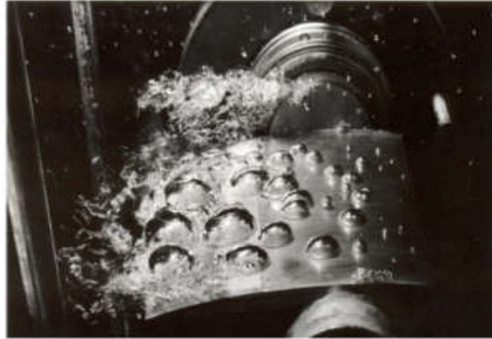
Fig. II.3 Cavitation à bulles sur un profil d'aile
