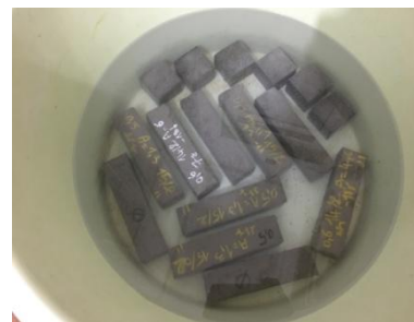
Figure (II.3): Les éprouvettes 4x4x16 cm 3 et 5x5x5 cm 3 Figure (II.4): Conservation à l'eau.
