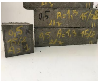
Figure (II.3): Les éprouvettes 4x4x16 cm 3 et 5x5x5 cm 3 Figure (II.4): Conservation à l'eau.
