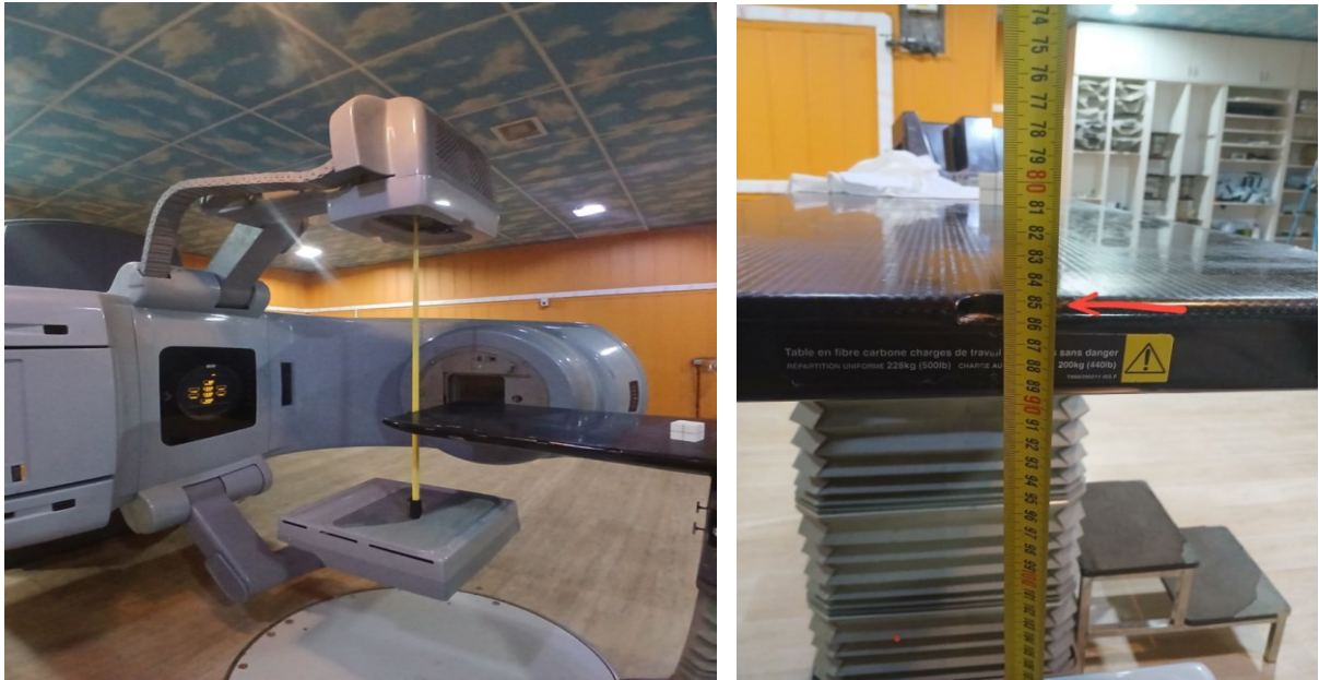
Figure 3.14 : Vérification du positionnement vertical de la source kV à l'aide d'un mètre-ruban
