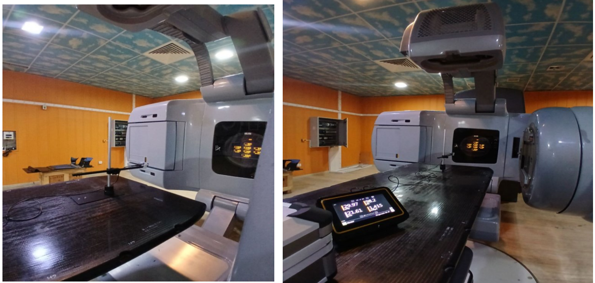
Figure 3.15 : Positionnement du fantôme sur la table avec le KVpmètre centré à l' isocentre
