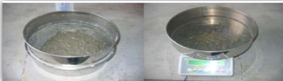
Fig. I-1-15. Essai de stabilité au tamis.
