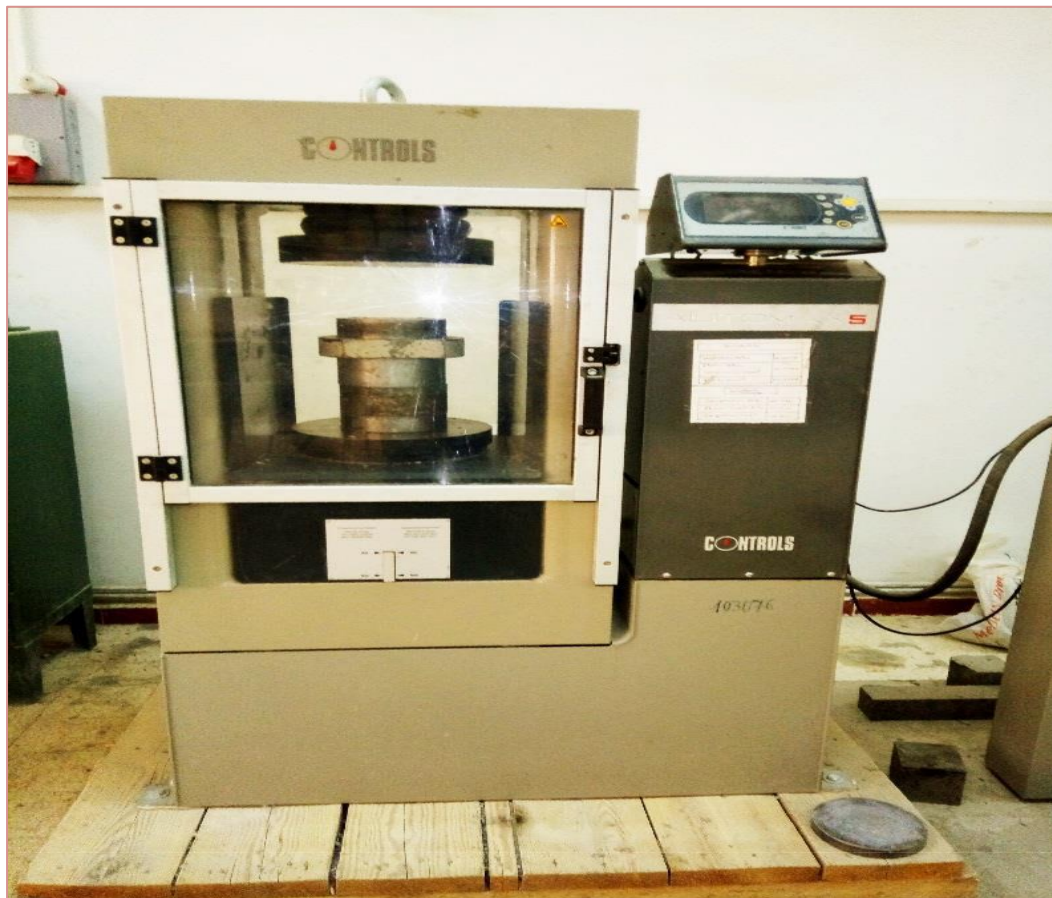
Fig. I-1-16. Mesure de la résistance à la compression.
