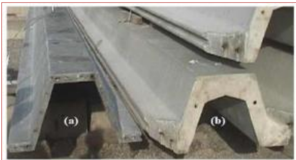
Figure I-3-5. Palplanches précontraintes à base de mortier autoplaçants fibré (a), béton armé ordinaire (b).
