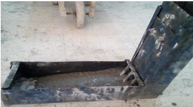
Figure .IV.4 : Essai de Boîte en L exécutés au laboratoire.
