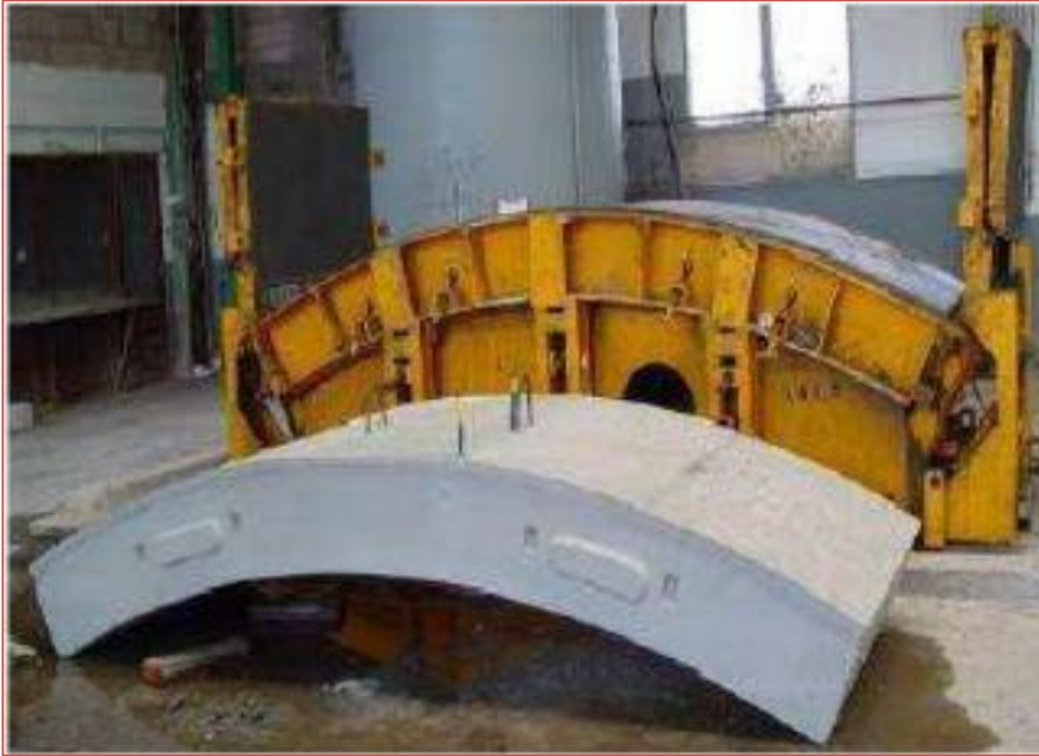
Figure I-3-6. Un voussoir à base de BAP fibré.
