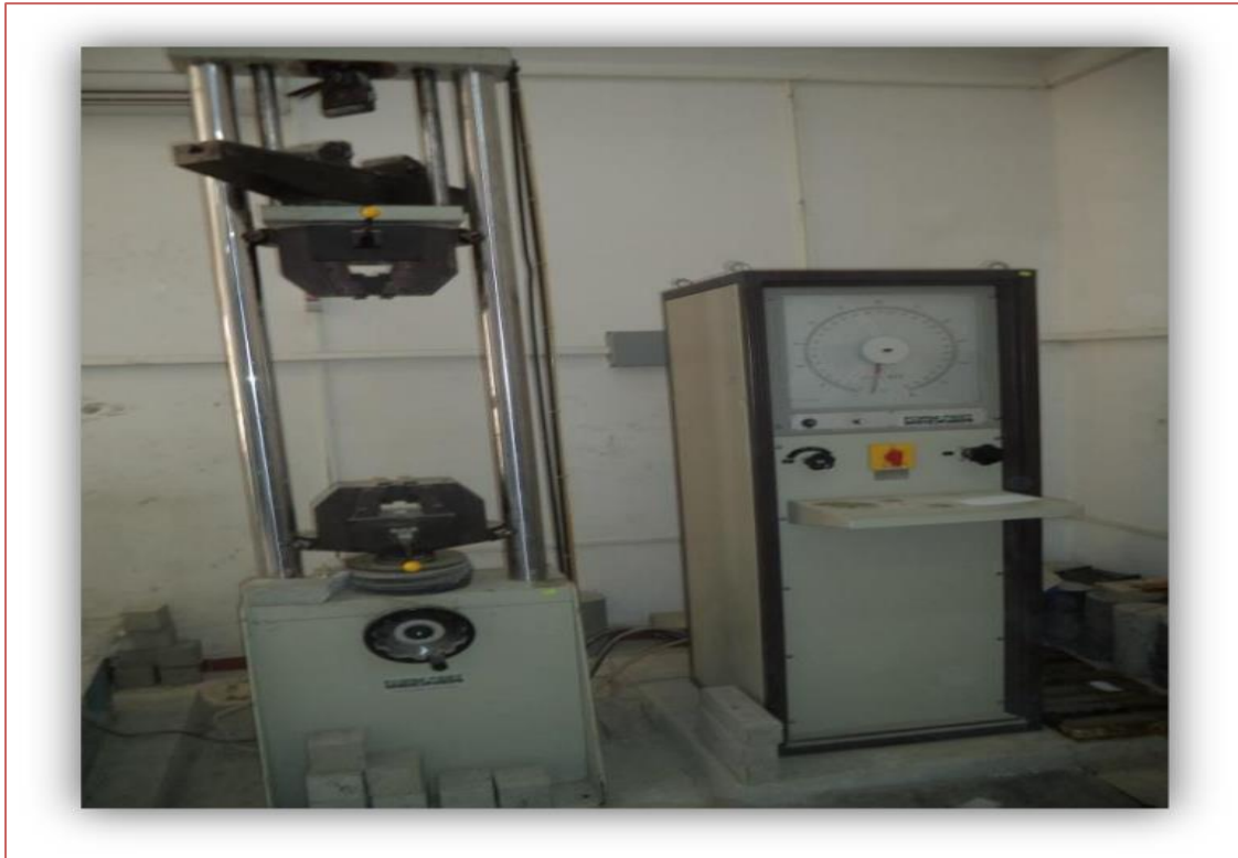
Fig. I-1-17. Mesure de la résistance à la traction par flexion (capacité 150 KN).
