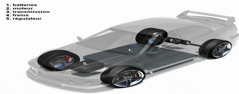
Figure III.4: la constitution voiture électrique. [26]
