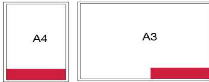
Figure I.10 Exemple de position du cartouche
