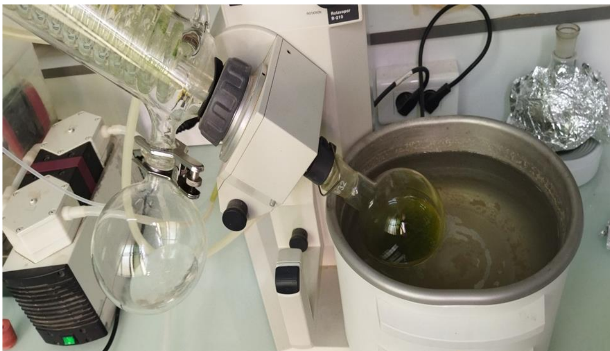
Image 2. Procédé d'extraction des solvants par dispositif Rotavapeur utilisé dans l'étude.
