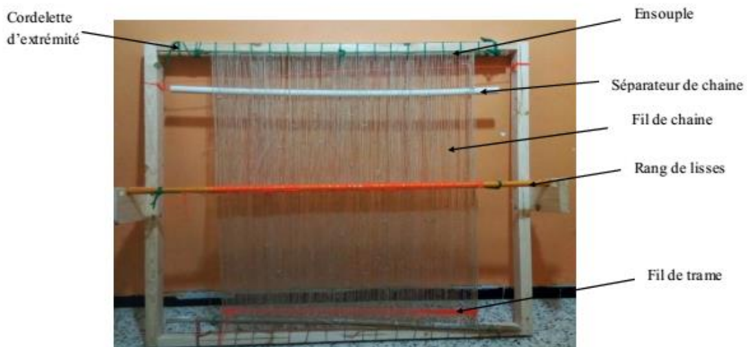
Figure 49: Métier à tissu fabriqué. [54].
