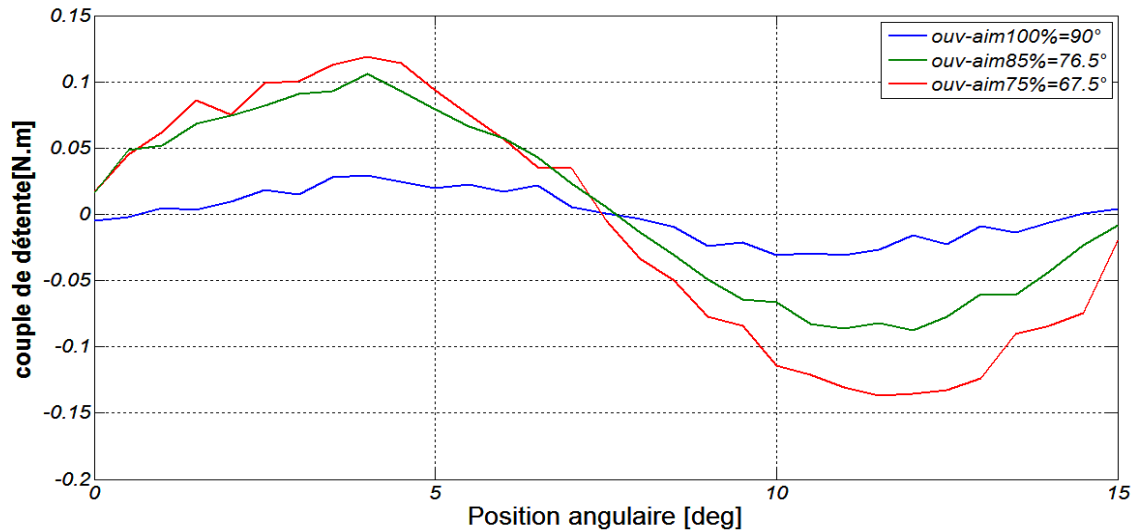
Figure. II.23 couple de détente pour une différente ouverture des aimants (hauteur des aimants égale 3 mm)
