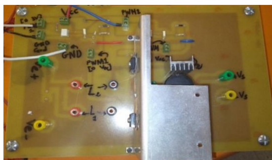
Figure(III.4): Photo du convertisseur boost entrelacé à deux bras réalisé.
