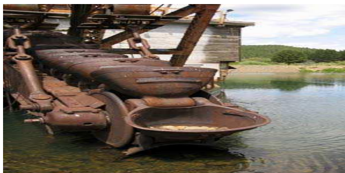
FIGURE I.11 CHAÎNE DE GODET
