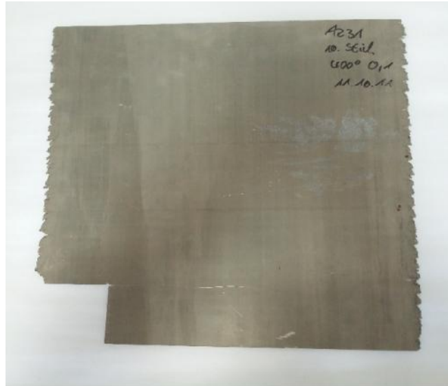
Figure II.1: Photographie de la tôle de l'alliage AZ31 (Mg-3Al-1Zn (%pds.)).
