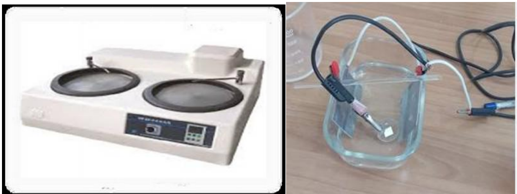
Figure II.5 : a)Appareil de polissage et b)polissage électrolytique.
