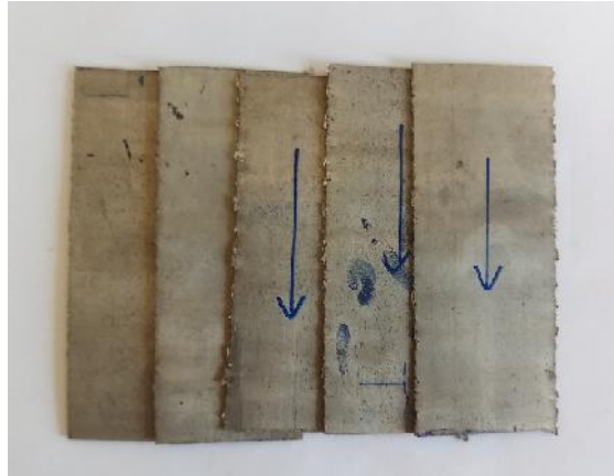
Figure II.2: L'alliage AZ31 après le laminage à chaud jusqu'à 70% de réduction d'épaisseur.
