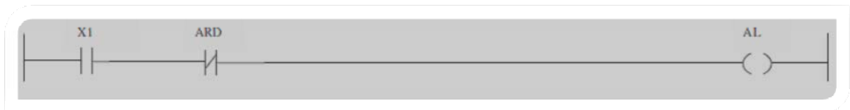
Réseau 22: Initialisation de M-1(moteur 1)
