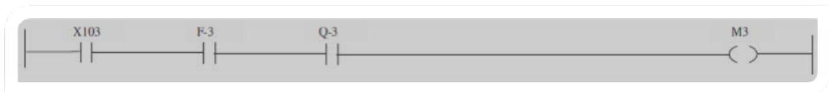
Réseau 33 : lampe rouge de M-3
