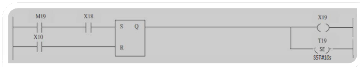
Réseau 18 : l'activation et la désactivation d'étape 19
