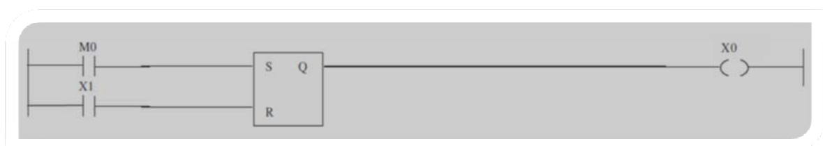
Réseau 2 : l'activation et la désactivation d'étape 0
