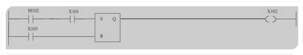
Réseau 6 : transition d'étape 103 (autorisation de marche automatique)
