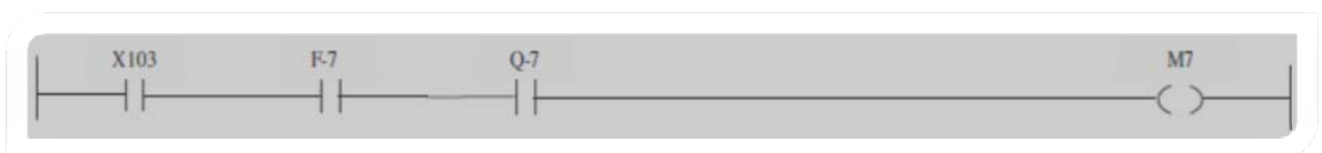
Réseau 53 : lampe rouge de M-7
