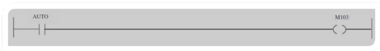
Réseau 6 : transition d'étape 103 (autorisation de marche automatique)
