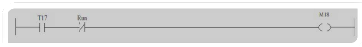
Réseau 16 : l'activation et la désactivation d'étape 18
