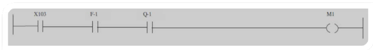
Réseau 23 : lampe rouge de M-1
