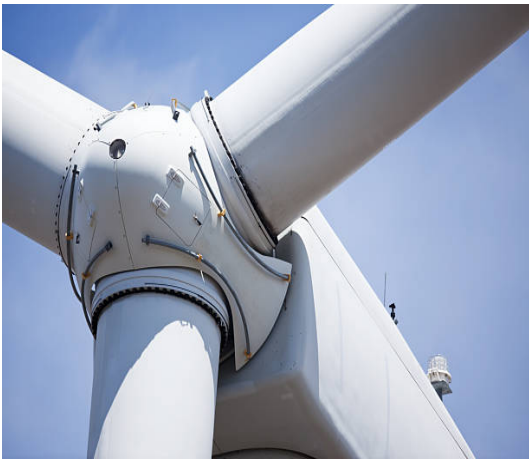
(a) Moyeu d'une éolienne à trois pâles.
