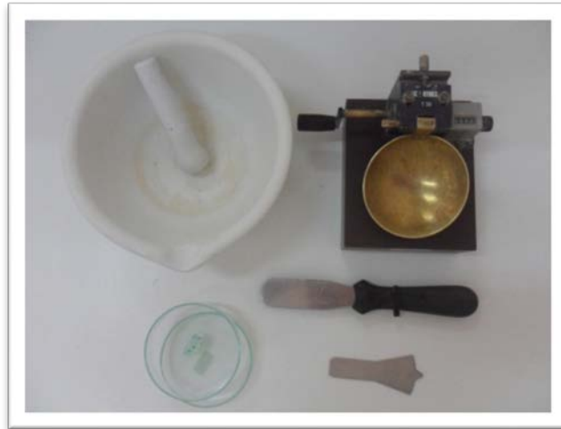
Fig. III-6 : Matériels spéciaux Pour la limite de liquidité.
