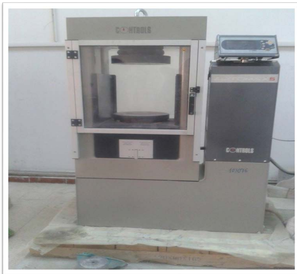
Fig. IV-42 : Essai de compression par écrasement.
