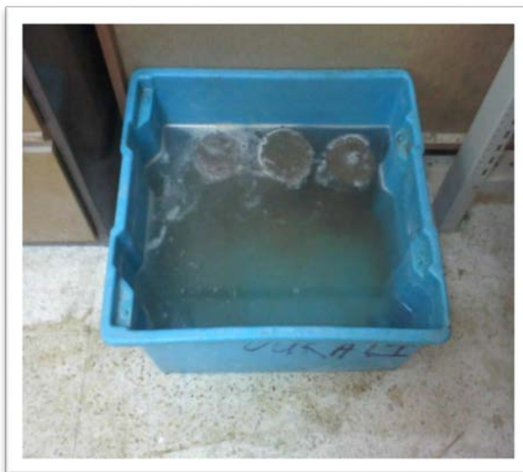
Fig. IV-28 : Essai de mouillage-séchage.
