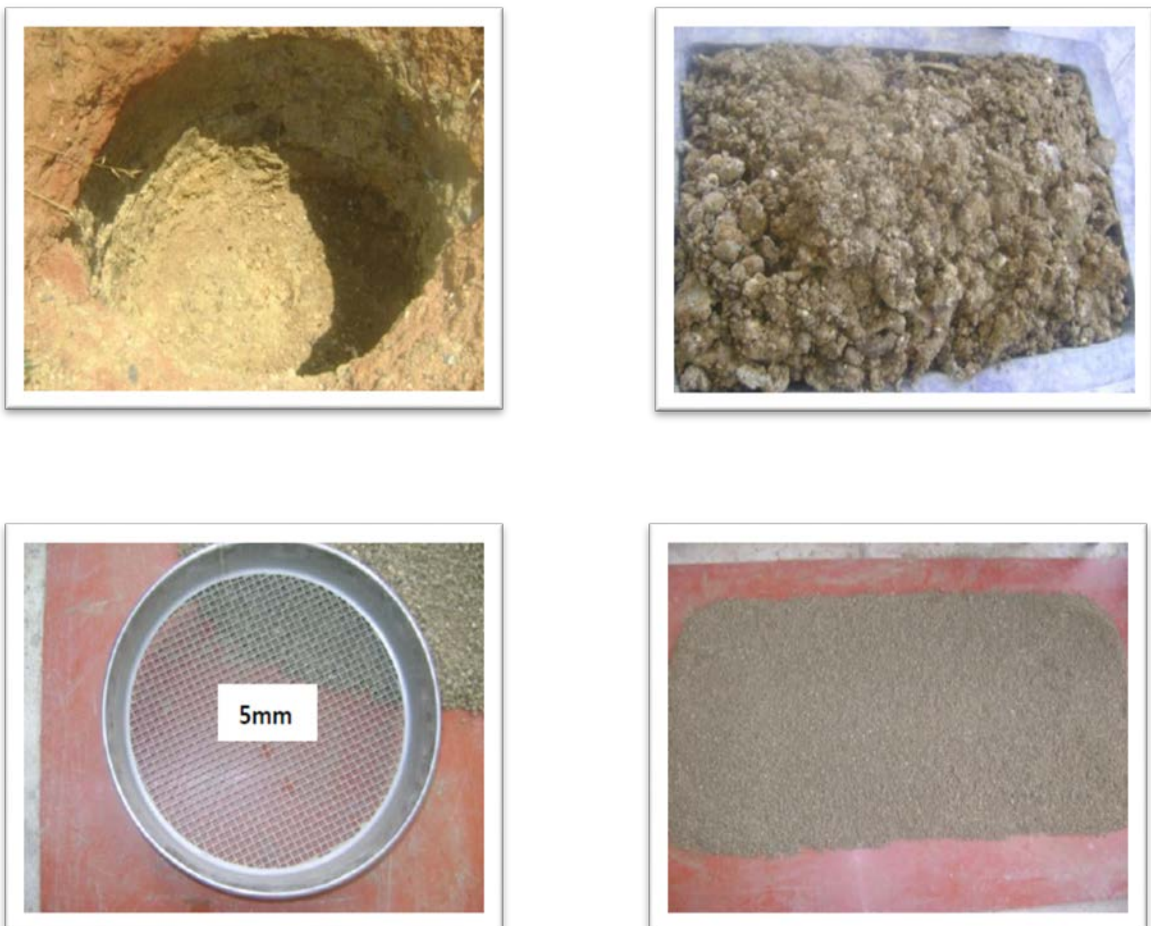
Fig. III-9 : Etapes de préparation de la terre.
