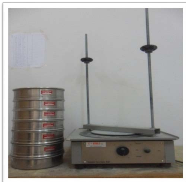
Fig. III-4 : Appareillage d'analyse granulométrique
