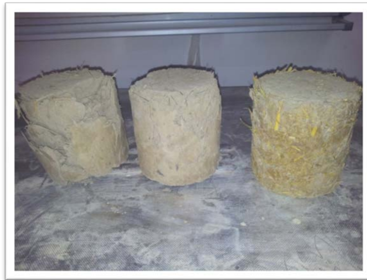
Fig. IV-33 : Etats des éprouvettes après l'écrasement .
