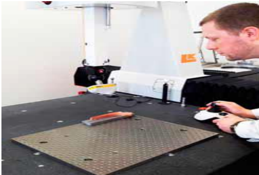
Figure II.2 : Scanne de pièce moins complexe (électrode) [11].
