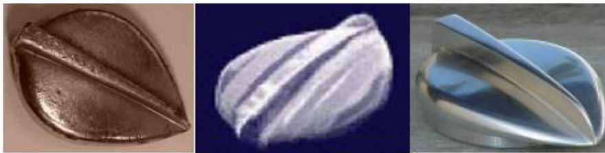
Figure I.5 :Rétro-conception d'un bouchon de voiture (Delahaye) [7]
