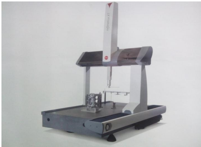
Figure II.11 : Machine à mesurer tridimensionnelles MMT (MEI M'sila).
