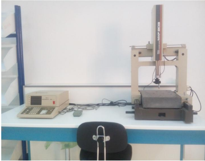
Figure II.10 : Machine à mesurer tridimensionnelles MMT MXF 203 (Université de M'sila).
