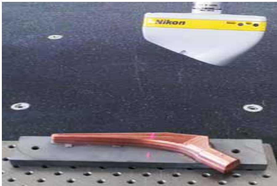
Figure II.1 : Numérisation d'une forme quelconque (électrode)[11].
