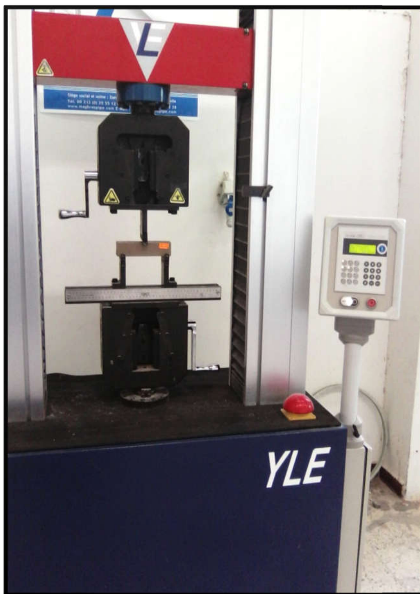
Fig. IV.15: Essai de FTP (YL Testing Machines/20Kn).
