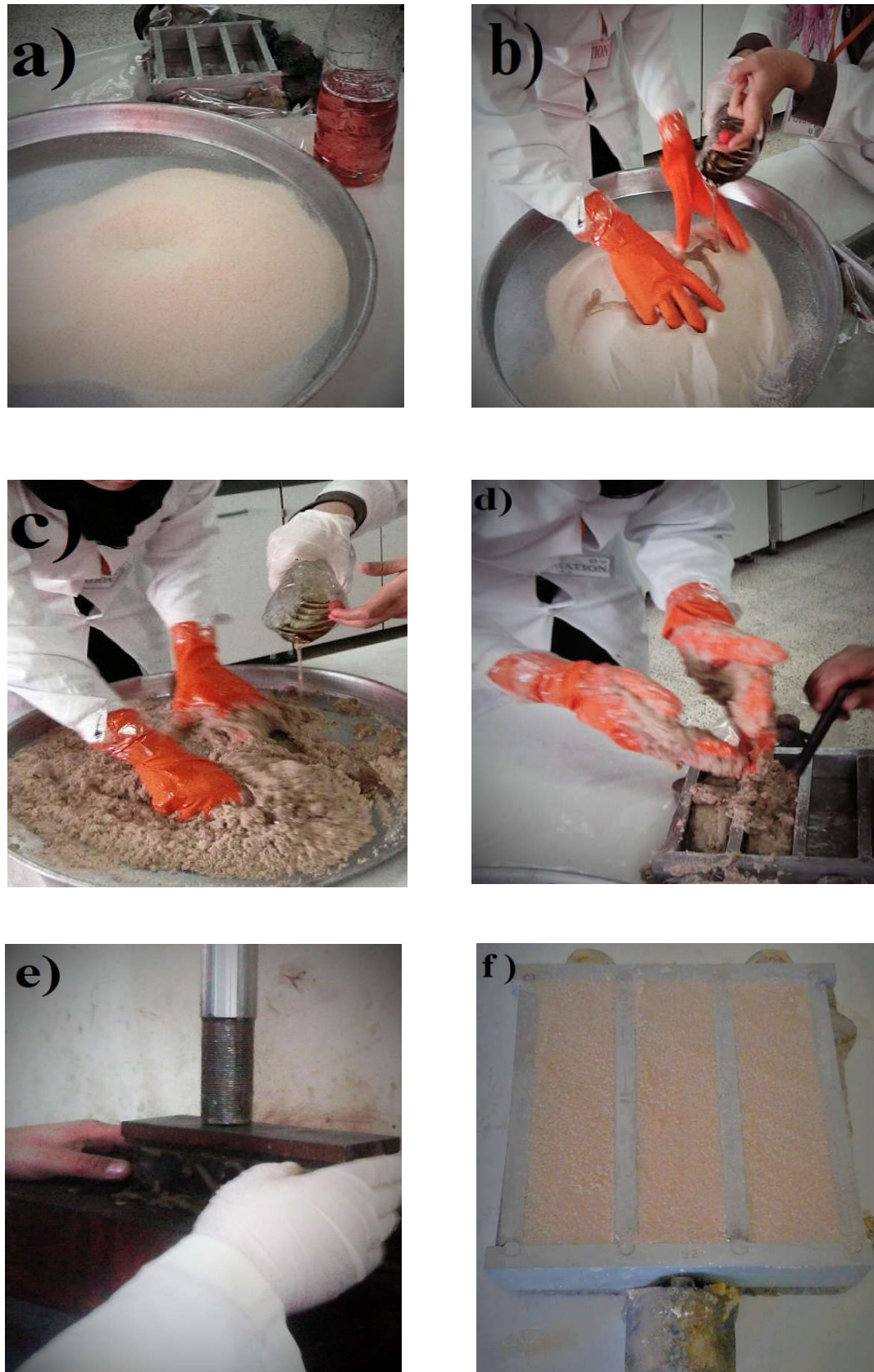
Fig. IV.11: Etapes de moulage de béton polymère par contact.
