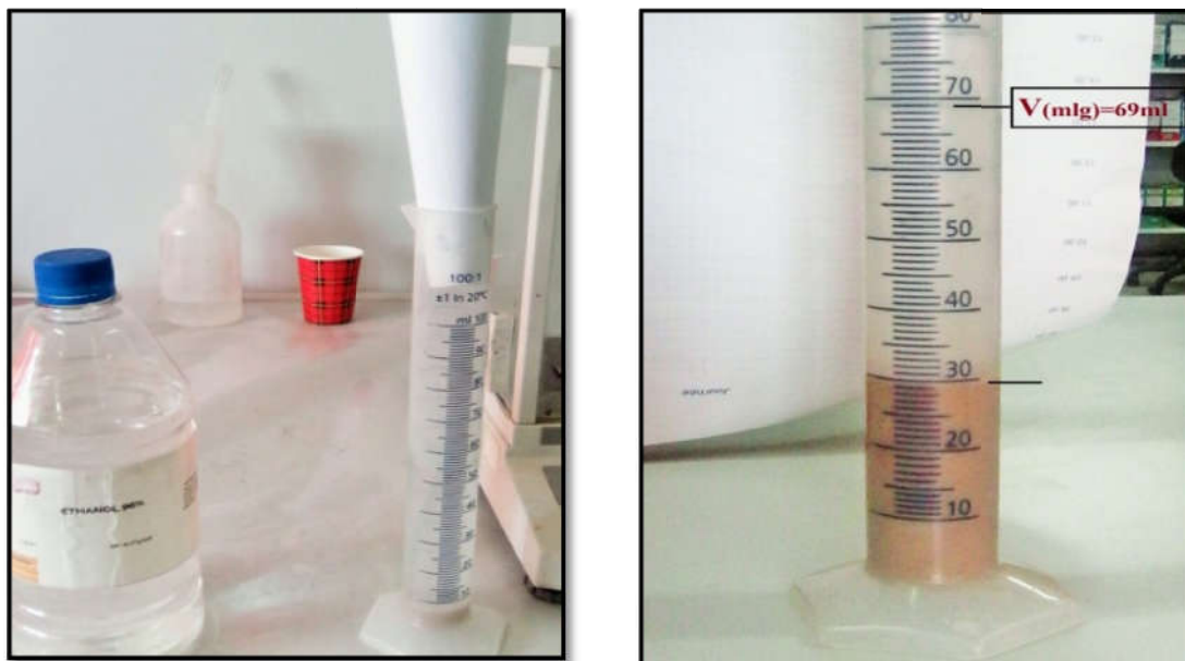
Fig. IV.5 : Essai de mesure la masse volumique.
