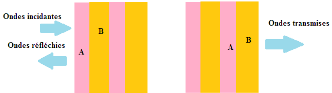
Figure I.3: structure unidimensionnelle formée par l'empilement de deux couches A et B de propriétés élastiques différentes.
