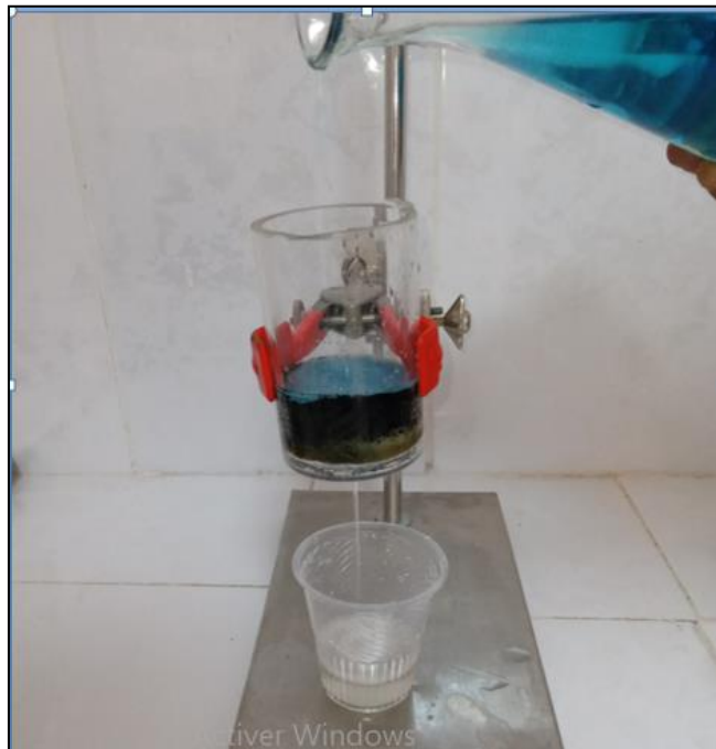
Figure IV.13. Filtration d'une solution de bleu de méthylène à travers une couche en poudre de charbon actif
