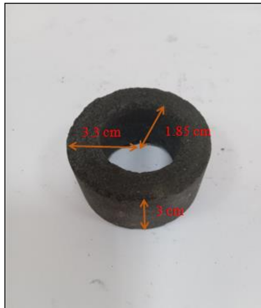
Figure IV.15. Eprouvette de test du filtre commercial (éprouvette de référence)
