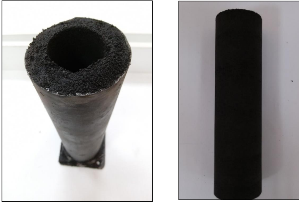
Figure IV.22. Fabrication du filtre CAP avec un liant hydraulique (ciment)
